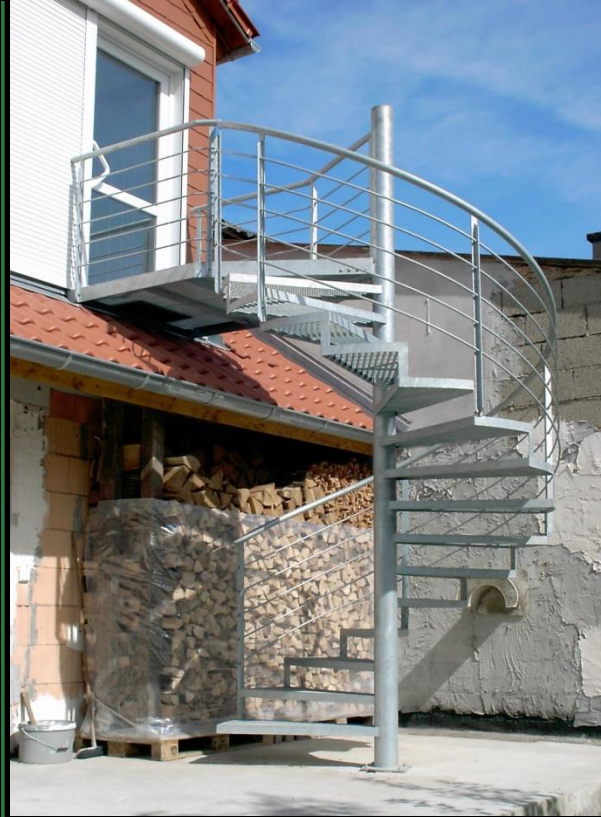
Spindeltreppe T- Stützen- geländer mit Stahlhandlauf Trittstufen aus Gitterrost Maschenweite 30/10
